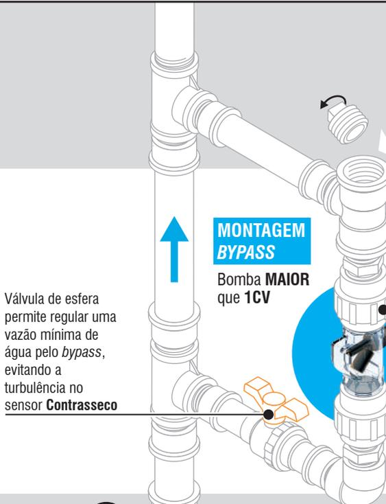
Válvula de esfera permite regular uma vazão mínima de água pelo *bypass*, evitando a turbulência no sensor **Contrasseco**
