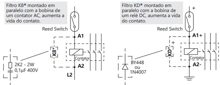
? **Risco de falha (solda do contato do Reed Switch)** em decorrência da CAPACITÂNCIA, pode ocorrer em função da distância e do cabo utilizado na ligação ao contator.
