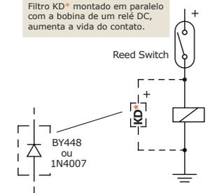
? Risco de falha (solda do contato do Reed Switch) em decorrência da CAPACITÂNCIA, pode ocorrer em função da distância e do cabo utilizado na ligação ao contator.
